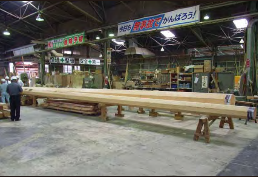
02 心柱加工検査
