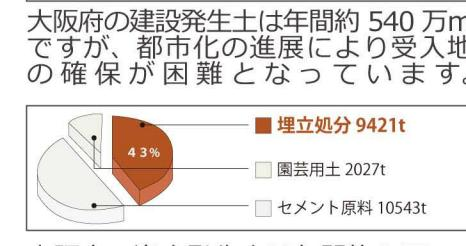
大阪市の浄水発生土は年間約 2 万 t ですが、43%が有効利用されず埋立て処分されています。
