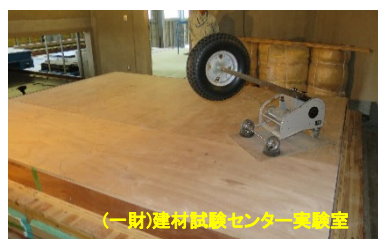
バンクマシンによる加振状況
